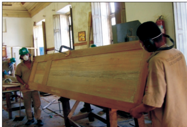
Figura 25. Trabalho de confecção das esquadrias na marcenaria da Escola Oficina de Salvador.
